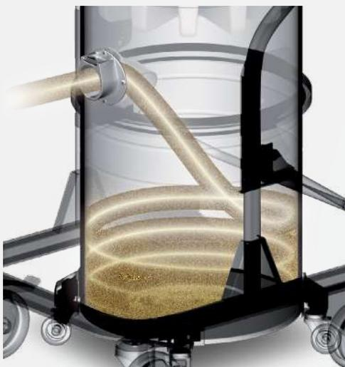
Универсальный пылесос, подходящий для сбора любого материала, будь то жидкие или сухие вещества, оснащён центральным впуском, который, благодаря наличию дефлектора, направляет поток жидкости вниз, чтобы избежать намочания фильтра. Система всасывания пыли менее эффективна по сравнению с тангенциальным впуском, так как дефлектор существенно замедляет поток порошкообразной субстанции, которая гораздо легче притягивается к фильтру.
