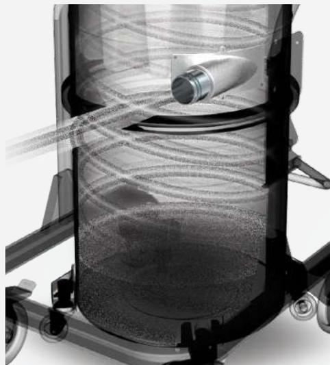
Наилучшая конструкция для сбора пыли у впуска тангенциального типа, поскольку скорость воздуха в контейнере выше, чем при применении прямого центрального впуска, что создаёт эффект циклона и способствует лучшему отделению пыли от фильтра.
